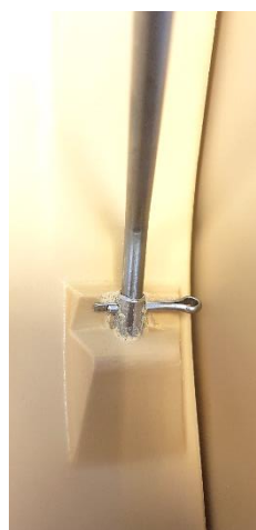
Splint presses igjennom hull slik som p  bilde og b yes til med tang for feste ytterligere
